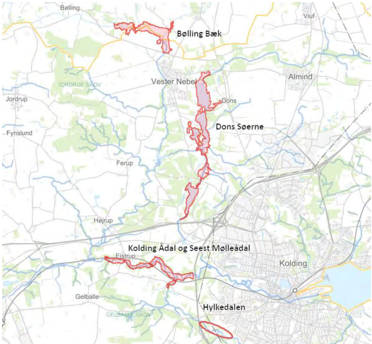
Figur 2-1 De tre delområder, som er udpeget i COWIs analyse (oplandsrapporten) samt det allerede gennemførte projekt i Hylkedalen. Delområderne kan tilsammen rumme den nødvendige tilbageholdelse ved en beregnet 100-års hændelse, op til 2,3 mio. m 3 . Nærværende naturvurdering beskæftiger sig alene med det sydligste delområde, kaldet E45.
